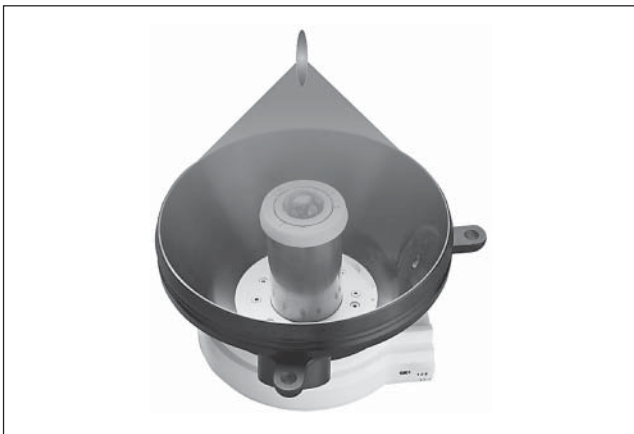
Abbildung 12: Elektromagnetische Stoßwellenerzeugung, Zylinderspule und Parabolreflektor. Eine Spule wird um einen Hohlzylinder gewickelt und mit einer Isolierschicht und einer leitfähigen Membran abgedeckt. Ein Stromstoß erzeugt abstoßende elektromagnetische Kräfte, die der Geometrie der Anordnung entsprechend eine zylindrische Druckwelle quer zur Zylinderachse abstrahlt. Durch Reflexion am Parabolreflektor wird die Welle in eine konvergente Kugelwelle transformiert und in der Therapiezone konzentriert.
