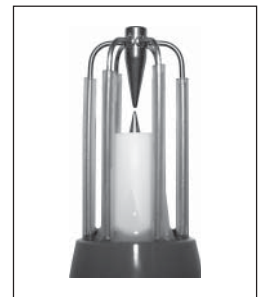
Abbildung 3: Elektrodenspitzen zur Erzeugung elektrohydraulischer Stoßwellen durch Unterwasserfunkenentladung.
